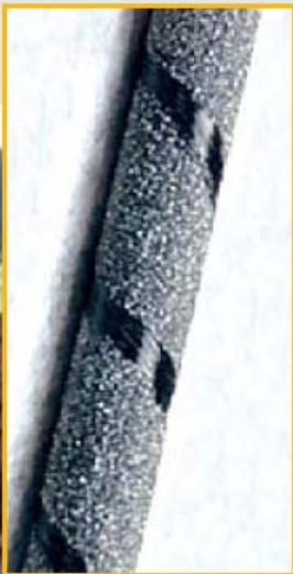
Detalhe das barras utilizadas de 5mm de diâmetro.
