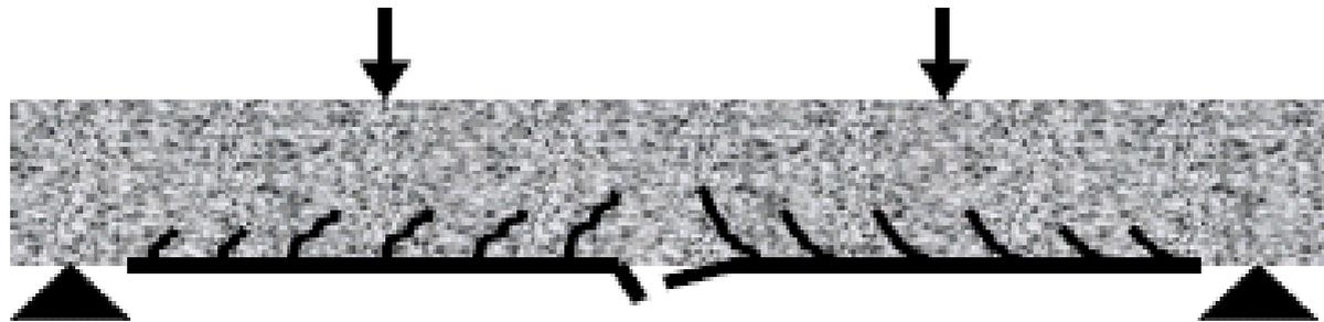
Figura 3.1– Ruptura por alongamento da armadura; adaptada de LOPES (2002).
