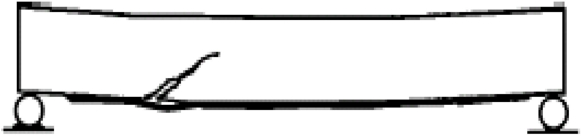
destacamento do reforço em fissuras inclinadas devido às suas aberturas horizontal e vertical
